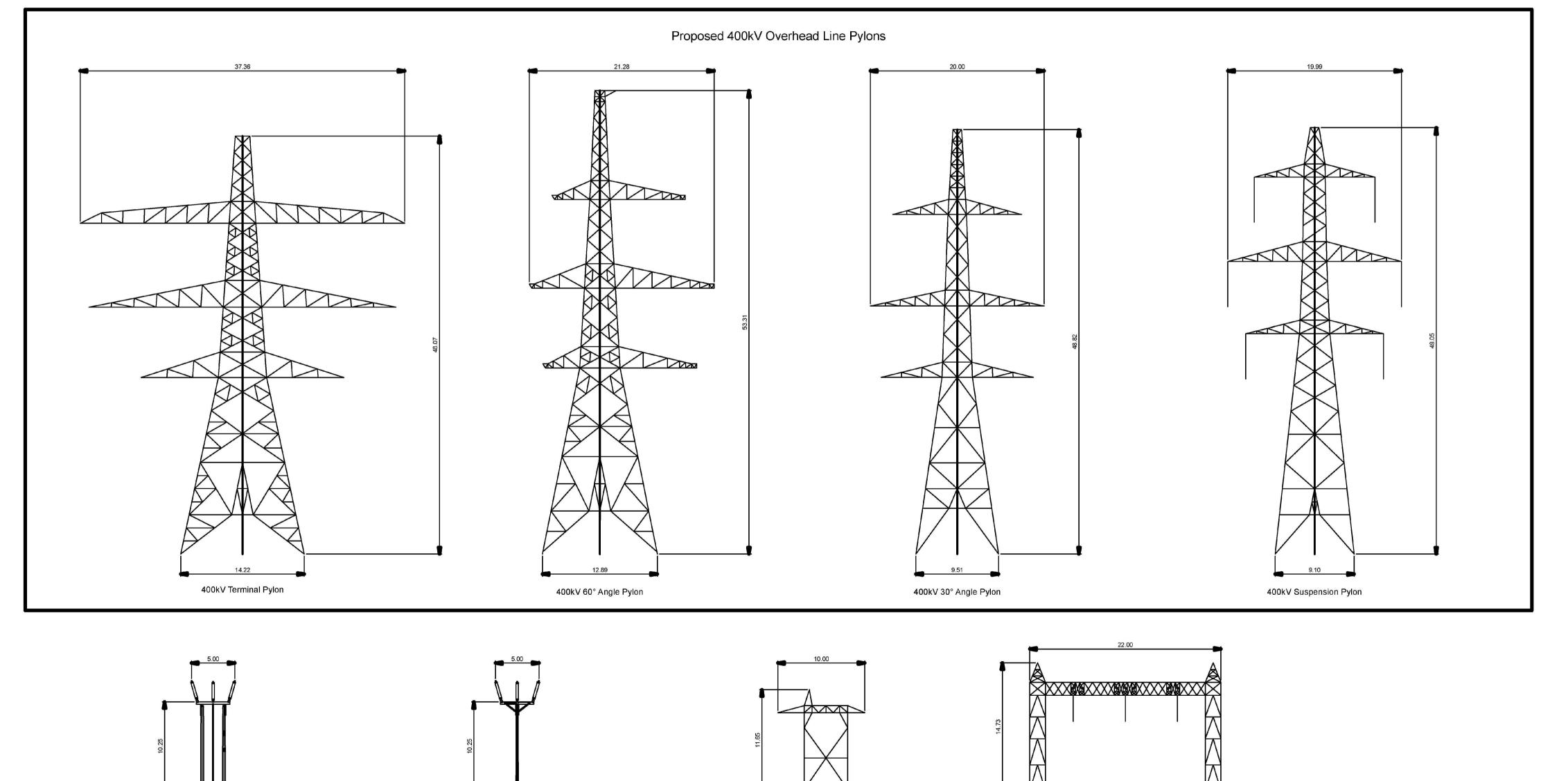
LOW HEIGHT LATICE PYLON SINGLE CIRCUIT 132kV OPERATION 400kV FULL LINE TENSION GANTRY
